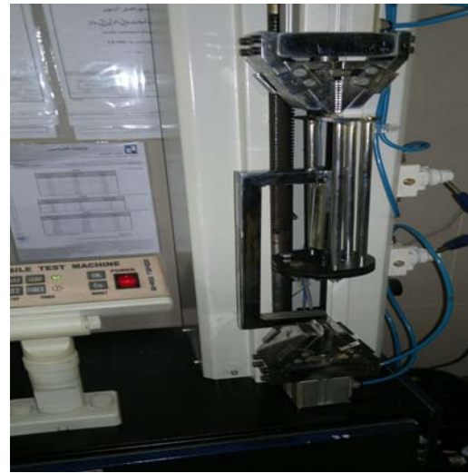
شکل (۳) - دستگاه اندازه گیری مقاومت کششی PBGM
