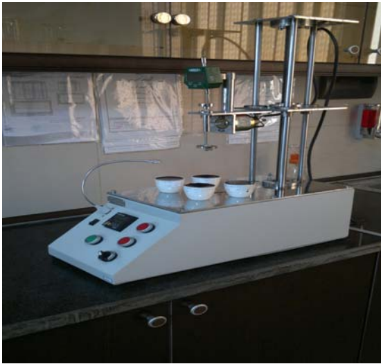
شکل (۴) - اندازه گیری درجه نفوذ قیر مورد استفاده در PBGM و پرایمر
