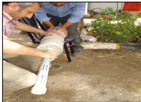
آزمایش میزان نشتی آب از طریق بارباکان
