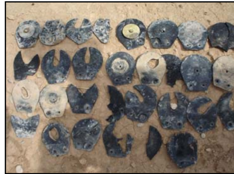
نمایی از درپوشهای تخریب شده بارباکان
