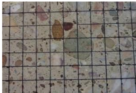
شکل ۴. نحوه مش‌بندی 1 \times 1 \text{ cm} مقاطع بتن برای تعیین DRI
