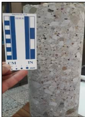
شکل ۶. مغزه از بتن سرریز سد کرخه
