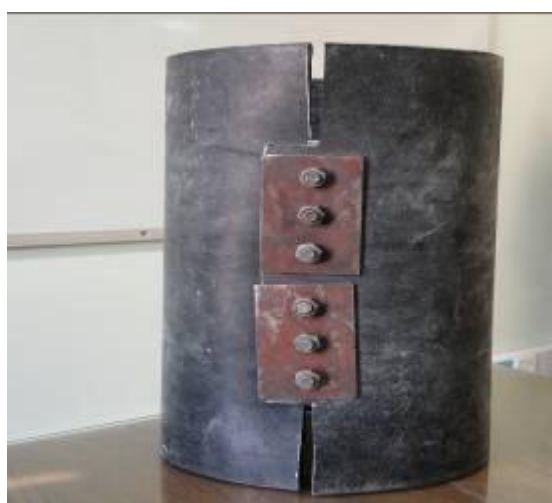
تصویر ۱۱: نمونه اولیه ساخت اتصال با ورق منجیت دار
