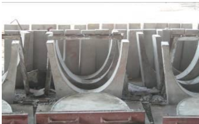
تصویر شماره ۳: زین های بتن مسلح که به عنوان تکیه گاه کانالت می باشند
